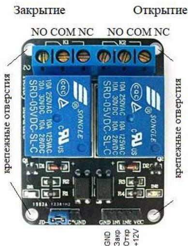
Стороннее оборудование подключается к клеммам реле открытого и закрытого положения в соответствии с требованиями оборудования. МСК подключается к плате «Цифра-1М» к разъему X18 и устанавливается с помощью дистанционных стоек через крепежные отверстия (см. Рисунок 8).
