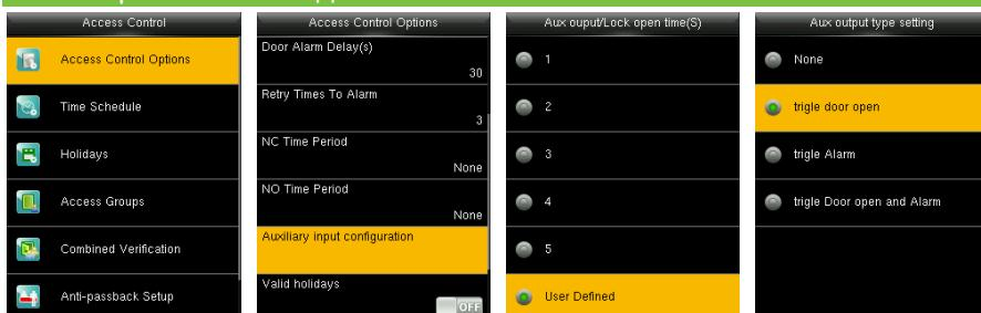
Нажмите M / OK> Контроль доступа> Опции контроля доступа> Настройка AUX выхода.
